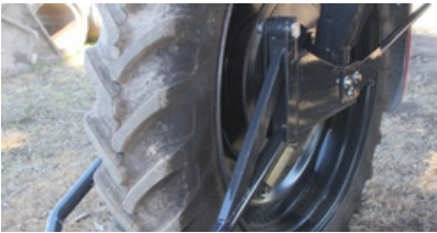
Sistema de frenos con 4 discos con mordazas de 2 pistones.
