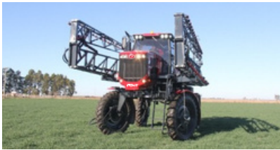
Posición de transporte con trabas laterales que evitan aperturas accidentales.
